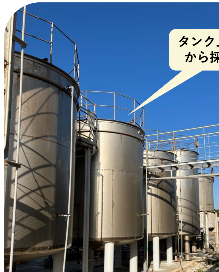
現在の食品用 屋外大規模培養設備 @石垣島
