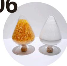
ユーグレナ社では、ユーグレナからバイオ燃料の原料となる脂質を抽出する工程で副産物として発生する残渣を配合したバイオマス含有度50%の「ユーグレナ・プラスチック」および、共同研究でユーグレナの特有成分「パラミロン」を使用したバイオマスプラスチック「パラレジジン®」を開発しています。
